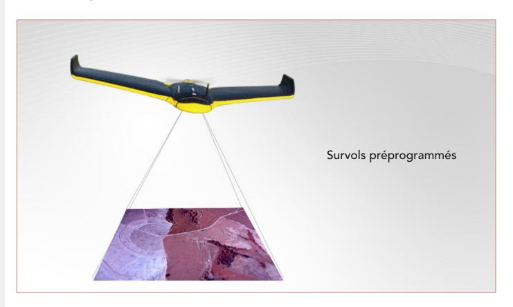
La photogrammétrie est l'extraction d'informations tridimensionnelles sur un objet à partir d'images du même objet prises à partir de positions et d'orientations différentes, avec un recouvrement entre chaque image.
